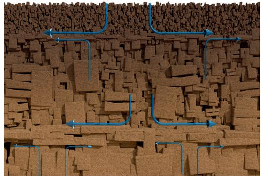
Une mauvaise structure du sol avec des changements de densité ou des couches compactées limite l'enracinement et l'écoulement de l'eau indiquée par les flèches bleues.
