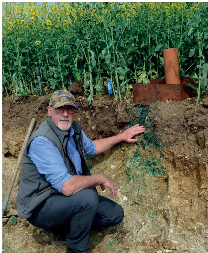
Dick Neale utilise un colorant bleu pour évaluer l'infiltration de l'eau en profondeur sur les sols à dominante argile lourde de l'exploitation familiale de Claydon.
