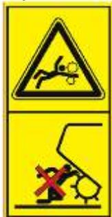
**Attention !** Ne pas s'approche des pièces d'alimentation lorsque la presse à balles en mouvement ou le tracteur en marche. Il est obligatoire de couper le moteur et le boîtier de commande lors des opérations d'entretien sur la machine.
