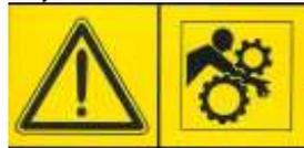
**Danger d'écrasement/cisaillement des arts supérieurs.** Ne s'approcher pas aux organes en rotation avec la presse ou le tracteur en mouvement. C'est obligatoire éteindre le moteur et le boîtier de commande pendant les interventions de manutention de la machine ;
