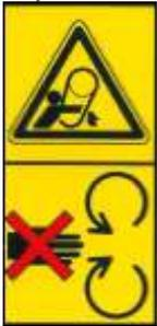
**Danger d'écrasement/cisaillement des arts supérieurs.** Ne s'approcher pas aux organes en rotation avec la presse ou le tracteur en mouvement. C'est obligatoire éteindre le moteur et le boîtier de commande pendant les interventions de manutention de la machine ;
