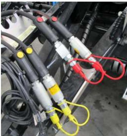
**Fig. 21 - Raccords hydrauliques presse à balles-tracteur**
