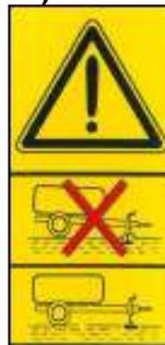
**Attention.** Utiliser un soutien additionnel si le pied de support de la machine vient appuyer sur un terrain particulièrement moelleux ;
