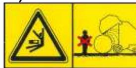
**Danger d'écrasement.** Ne stationner pas sur la zone opérative de la presse et en particulier pendant les opérations d'expulsion de la balle en la partie arrière de la presse ;
