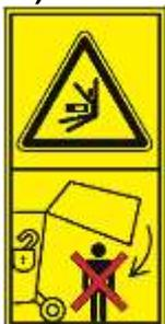
**Risque d'écrasement.** Ne pas s'approcher de la machine et ne pas se placer sous la zone de déchargement des balles avec la porte arrière ouverte sans activer au préalable les dispositifs de sécurité correspondants ;
