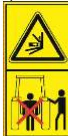
**Risque d'écrasement.** N'approchez pas de la zone entre le tracteur et la presse à balles rondes. Avant d'entrer dans cette zone, arrêtez le moteur, serrez le frein de stationnement du tracteur et assurez-vous que la presse à balles est stable ;
