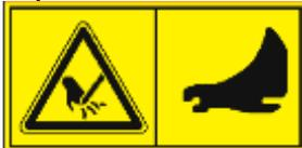
**Risque de cisaillement et de coupure des membres.** Ne pas s'approcher des couteaux de coupe. Il est obligatoire d'arrêter le moteur et le boîtier de commande lors des travaux de maintenance sur la machine. Utilisez des gants de protection pour manipuler les couteaux de coupe ;
