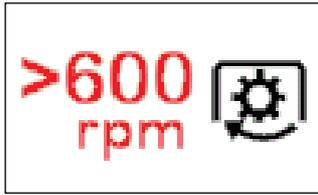
**Fig. 52 - Icône alarme vitesse prise de force**
