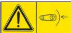
**Danger d'accrochage et cisaillement des arts.** Ne s'approcher pas aux organes en rotation avec la presse ou le tracteur en mouvement. C'est obligatoire éteindre le moteur et le boîtier de commande pendant les interventions de manutention à la machine ;
