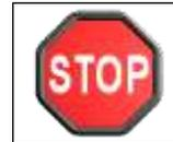
Le quel indique un alarme présent, la visualisation du symbole de stop se alterne à celui-là de l'état de la presse. Le terminal émette le sonné 5 ou 1. En ce cas il faut interrompre immédiatement le travail, s'assurer sur la cause de l'alarme, donc éliminer la cause pour suivre avec le travail.
