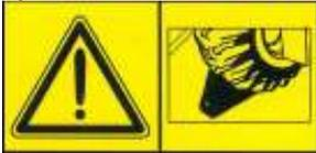
**Danger d'écrasement pour brusque movimentation.** Quand la presse vienne décrocher du tracteur, actionner le frein de stationnement ou utiliser les appropries coins à positionner dessus les roues ;
