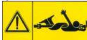
**Danger d'accrochage.** Il est absolument interdit de s'approcher des organes en cours de rotation (en particulier, l'arbre de cardan) à tracteur en marche ;
