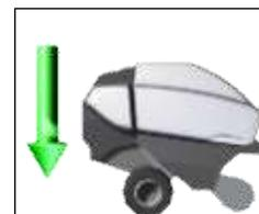
Etat 2 : Porte arrière fermé et bras tendeur de hors position. La presse devienne blanche avec la porte arrière fermé, une flèche verte apparaît que signale
