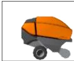
Etat 4 : Diamètre maximum presque atteint. La presse devienne orange et le terminal émette le sonné 2 pour inique que prochainement sera nécessaire fermer le ramassage.
