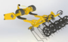
Placement de l'engrais sur la dent de semis (placement de l'engrais au-dessus de la graine)
