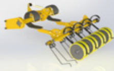
Placement de l'engrais sur la dent fissuratrice (placement de l'engrais sous la graine)
