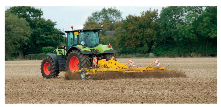
Der TerraStar® ermöglicht eine flache Bodenbearbeitung, lässt die Bodenstruktur intakt und arbeitet nur punktuell an der Bodenoberfläche.
