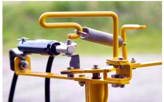
Hydraulische Fernsteuerung der Grenzsteuerung
