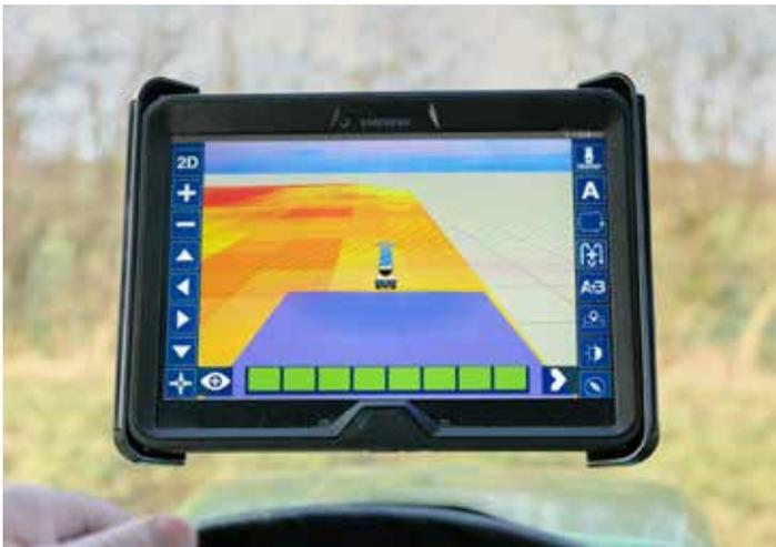
NAVI App zur GPS-unterstützten Düngung über ein Android-Tablet (erfordert CALIBRATOR ZURF).
