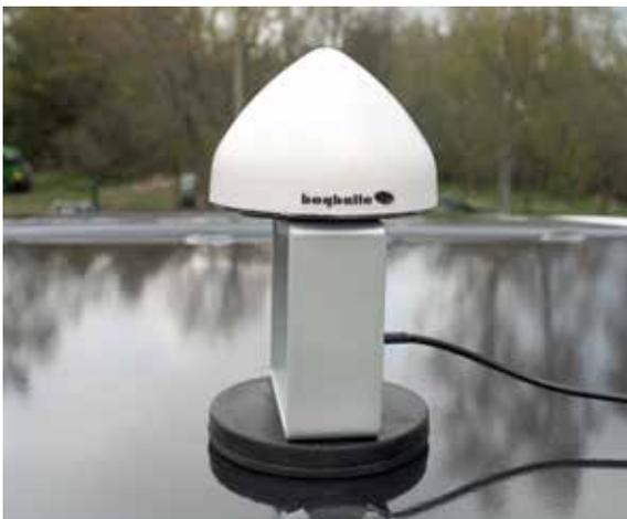
GPS-Antenne für NAVI Com Modul
