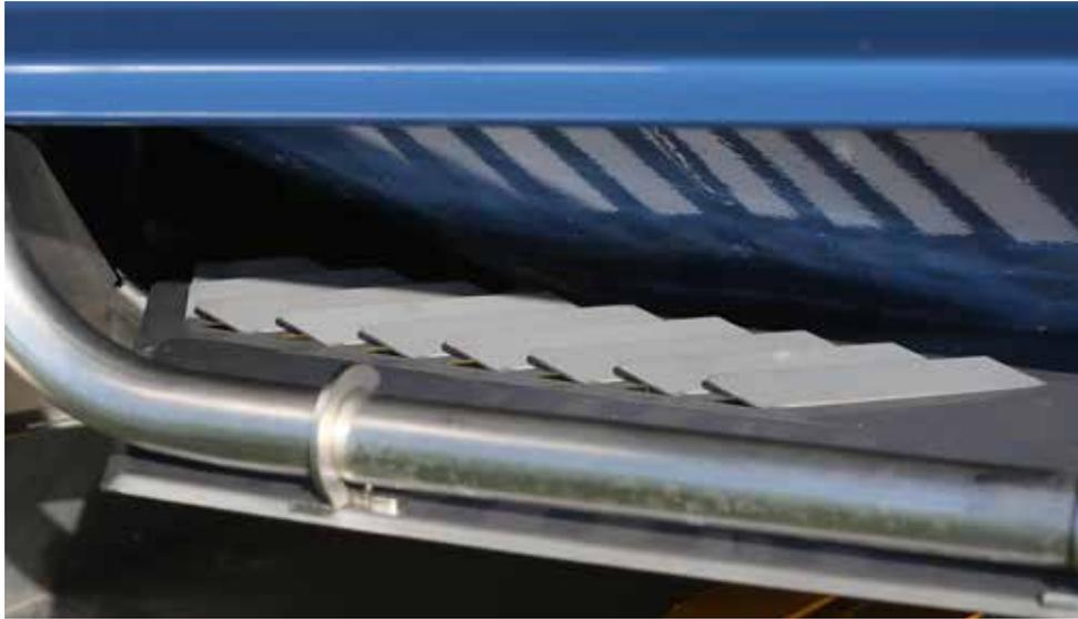
Die Rotation der Streuscheiben zieht einen kontrollierten Luftstrom durch die Lüftungsöffnungen der Schutzvorrichtung und gibt den Dünger gleichmäßig auf der Streuscheibe ab (M-Linie).
