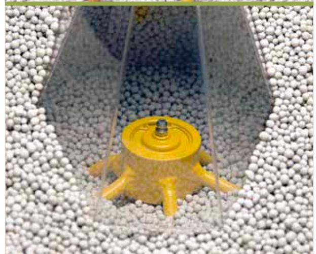
Die Exenterfreilaufprüherwerke sorgen durch eine sanfte und exzentrische Rotation für einen konstanten Düngerfluss.
