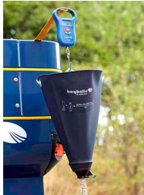
Der S-Indikator ist einfach zu bedienen und eine komplette Abdreprobe eines bestimmten Düngers wird in wenigen Minuten durchgeführt.
