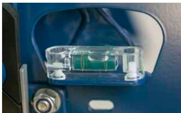
Der L15 (W) befindet sich immer in horizontalen Position. Um eine korrekte Montage zu gewährleisten, ist am Oberlenkerbock eine feste Wasserwaage angebracht.
