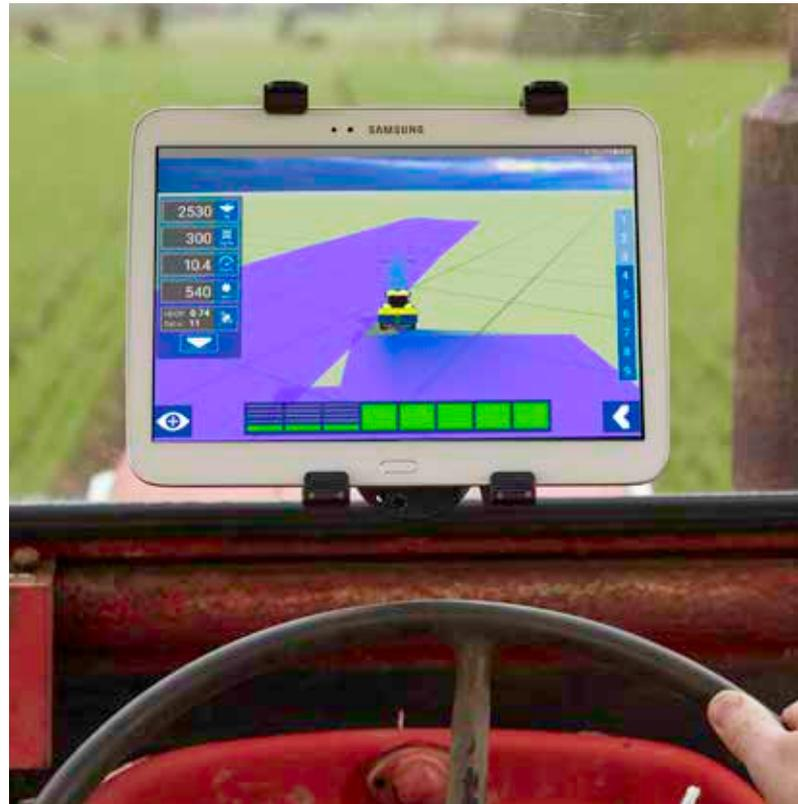
Verwenden Sie ein Android-Tablet für das vollautomatische Section Control und die Umsetzung variabler Streumengen über GPS. Auch der älteste Hofschlepper kann einfach mit modernster GPS-Technologie ausgestattet werden.
