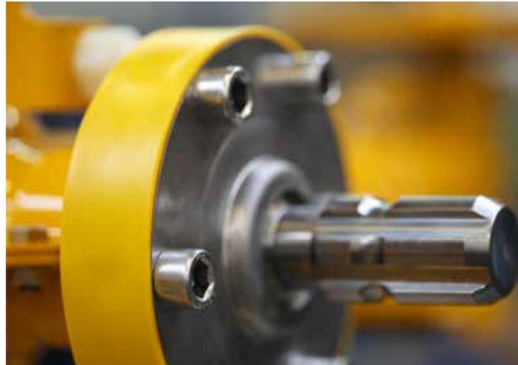
Die integrierte, wasserdichte und wartungsfreie Überlastkupplung schützt vor Schäden am Traktor, der Zapfwelle und des Getriebes bei einem Zapfwellenstart mit zu hohen Drehzahlen.
