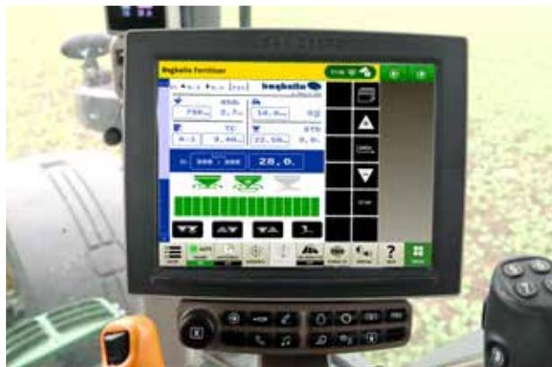
Bei elektronisch bedienten Steuern wird die ZW Drehzahl direkt am Monitor angezeigt.
