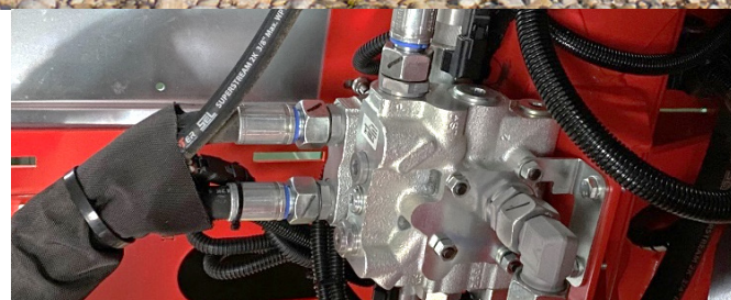
Das Bandventil bestimmt die Ablagerichtung und die Bandgeschwindigkeit – beides über das Terminal einstellbar
