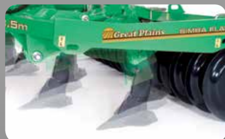
SYSTÈME À DÉCLENCHEMENT HYDRAULIQUE - Flatliner à déclenchement hydraulique - Les dents peuvent traiter des sols présentant une forte teneur en pierres et des états de terrain très variables. Chaque dent est hydraulique, offrant une action de déclenchement et réenclenchement rapide en cours de travail. La pression de réenclenchement automatique est réglable. Le système hydraulique est entièrement pressurisé pour obtenir une usure et une maintenance minimales.
